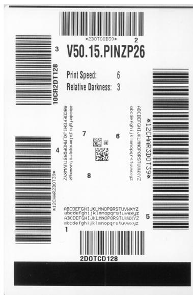
4. 그림 21 및 표 21을 참조하십시오. 테스트 라벨을 확인하여 어떤 것이 응용 프로그램에 가장 적합한 인쇄 품질인지 결정합니다. 바코드 확인 장치가 있는 경우, 이를 사용하여 바/공백을 측정하고 인쇄 명암을 계산합니다. 바코드 확인 장치가 없는 경우, 눈으로 확인하거나 시스템 스캐너를 사용하여 자가 테스트에서 인쇄된 라벨을 바탕으로 최적의 어둡기 설정을 선택합니다.
